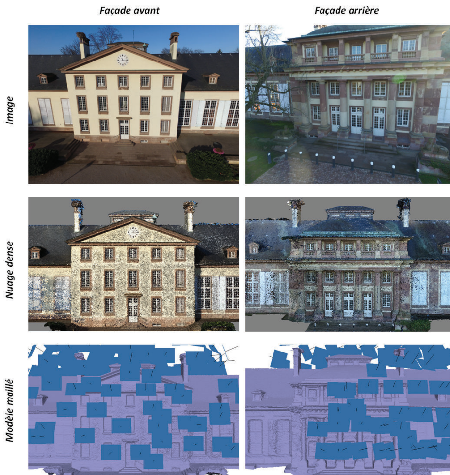
FIGURE 4.3 – Les deux façades principales du Pavillon Joséphine et les résultats de l'appariement dense ainsi que du calcul de maillage sur Photoscan. Les dernières images montrent les positions des caméras lors de la prise de vue.
