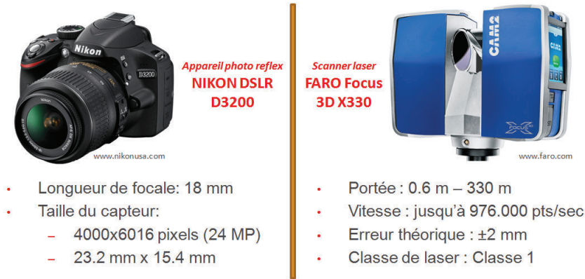
FIGURE 3.2 – Caractéristiques principales des instruments terrestres employés.
