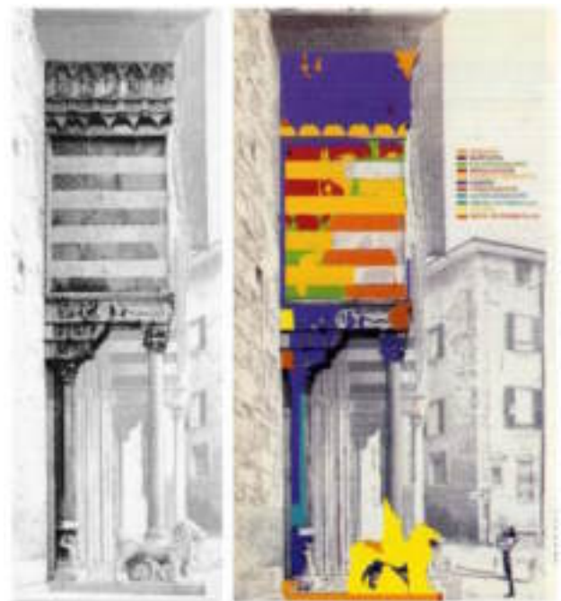
Figure 14. Santa Maria Maggiore in Bergamo, photographical straightening and matric-photological survey (Luigi Colombo, Grazia Tucci, 'ANAFKH 1, marzo 1993).
